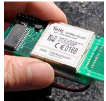
02 | Il dispositivo tag per la geolocalizzazione, progettato e prodotto specificatamente per il progetto Trash Track insieme alla ditta Qualcomm The geolocating tag, designed and produced with Qualcomm specifically for the Trash Track project
